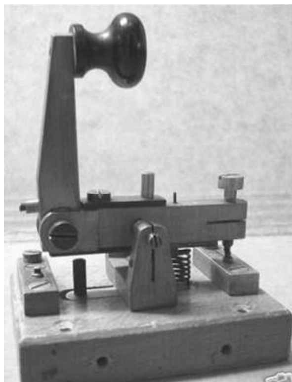
Manipulateur pour télégraphie par le sol position replié
